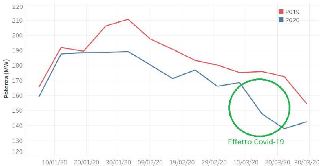
Figura 5. Confronto fra gli andamenti delle medie settimanali della potenza totale in MW, erogata nel periodo 1 gennaio-31 marzo 2020 e 2019 dalle cabine primarie considerate per la città di Milano.
